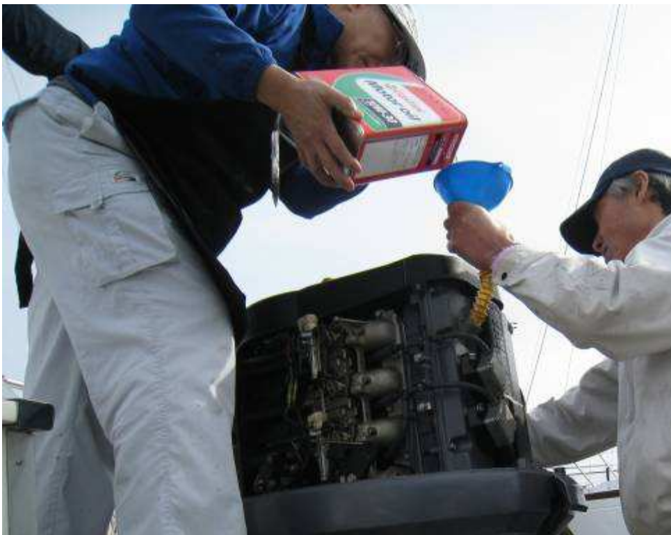
写真 7 エンジンオイルを注入する
