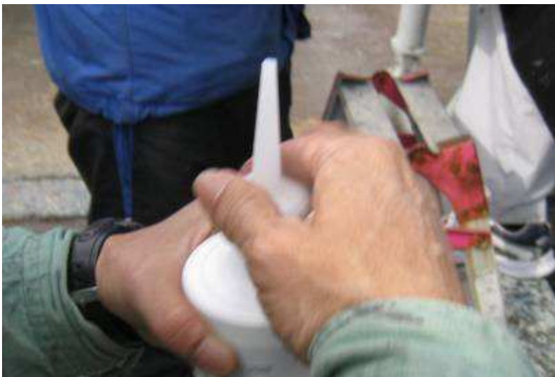
写真 12 オイルチューブにノズルを付ける
