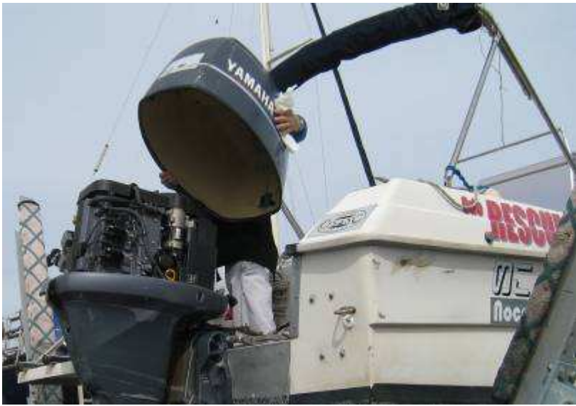
写真 6 エンジンカバーをはずす
