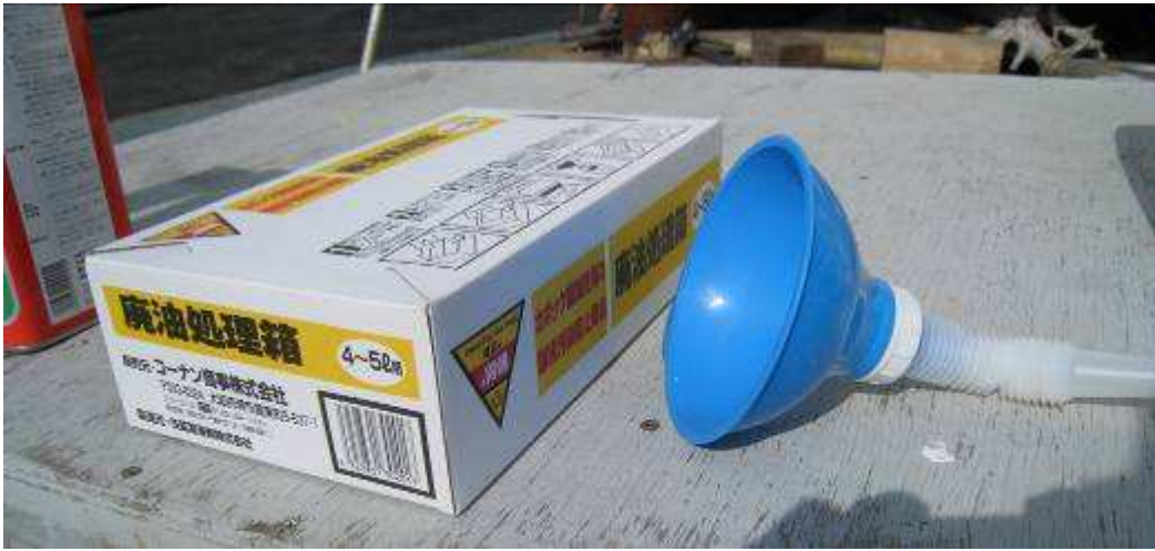
写真 2 廃油処理箱（左）とジョウゴ+ホース
