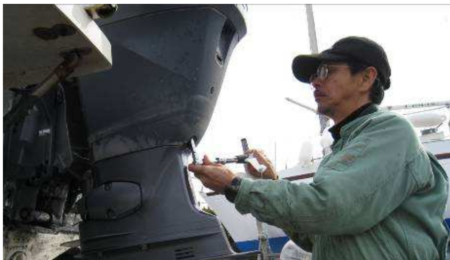
写真 4 エンジンオイル排出口ボルトをはずす
