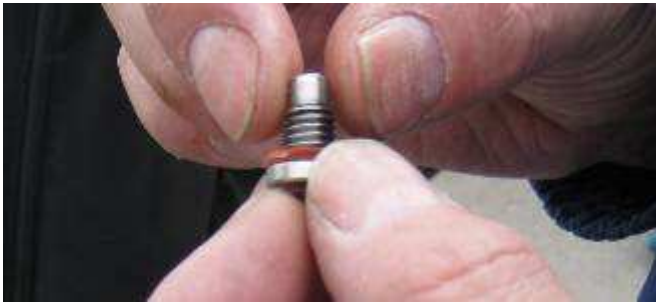
写真 10 プラグとガスケットパッキン
