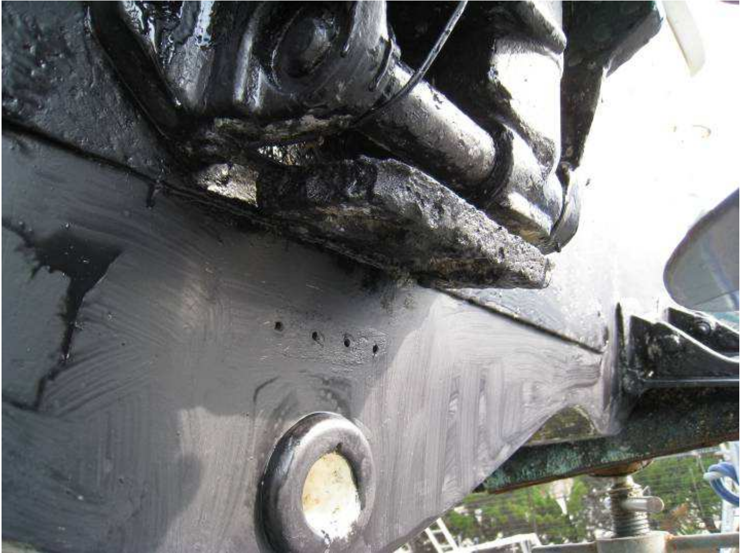
写真 13 エンジン取り付け部の直下にあるアノード（水平に付いている薄い直方体のもの）
