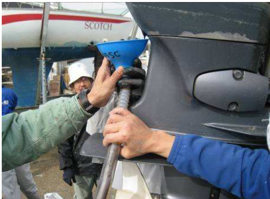
写真 5 排出口に「廃油受けキット」をセットする
